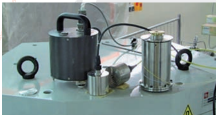
Capteur de vibration LAViSta.
