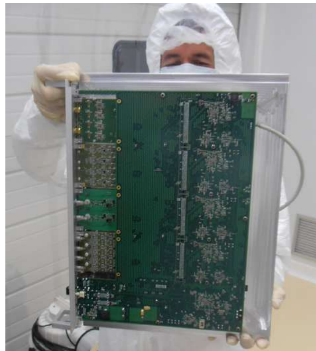
Figure 3 : Montage d'un radiateur sur une carte DAQ-Box avec quatre mezzanines, avant installation dans un caisson étanche sous un banc. Le radiateur sert à évacuer la chaleur vers les côtés du caisson et le banc qui l'évacuent ensuite, sous vide, par radiation.
