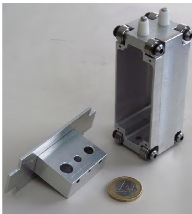
Figure 4 : Porte-sources circulant sur les rails du système « pantographe ». Les sources d'étalonnage sont insérées dans les encoches cylindriques.
