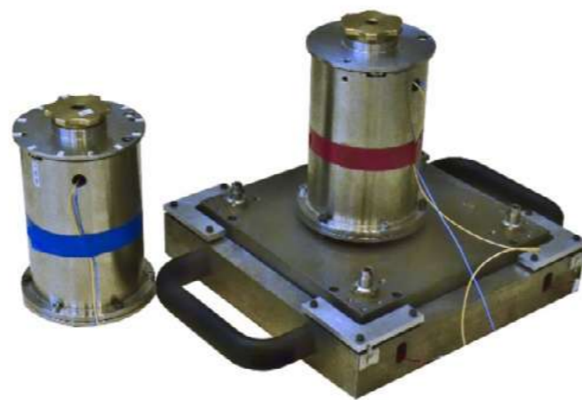
Figure 2 : Table active, capteurs de vibrations (bleu: mesure du mouvement du sol, rouge : contrôle feedback).
