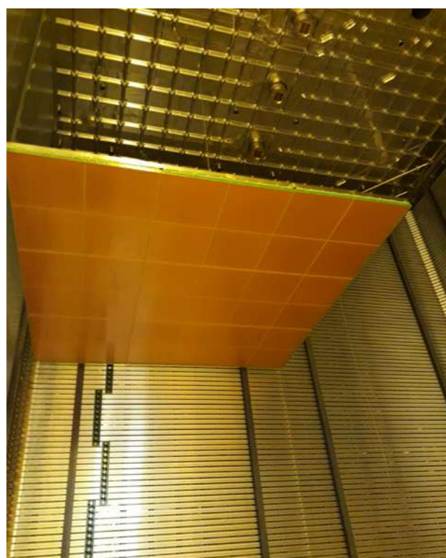
Figure 4 : Installation du premier CRP dans le cryostat de l'expérience ProtoDUNE-DP.
