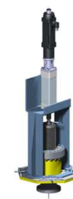
Photo ProtoDUNE : Une cheminée de suspension et positionnement des CRPs.
