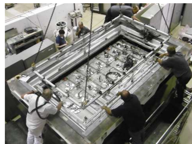
Figure 5 : Installation du système de calibration « pantographe » autour de la cuve de STEREO à l'intérieur des blindages le 31 août 2016.
