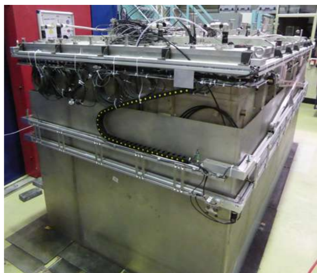
Figure 3 : Système de calibration externe dit « pantographe » posé sur la double cuve de STEREO lors des tests de positionnement en juillet 2016 : rails supérieur et inférieur guidant le porte-sources tout autour de la cuve contenant le liquide scintillant, moteur (noir) permettant ce déplacement dans le coin le plus proche de l'observateur et capteurs (verts) signalant à l'automatisme que le porte-sources a atteint les positions les plus avancée et reculée.
