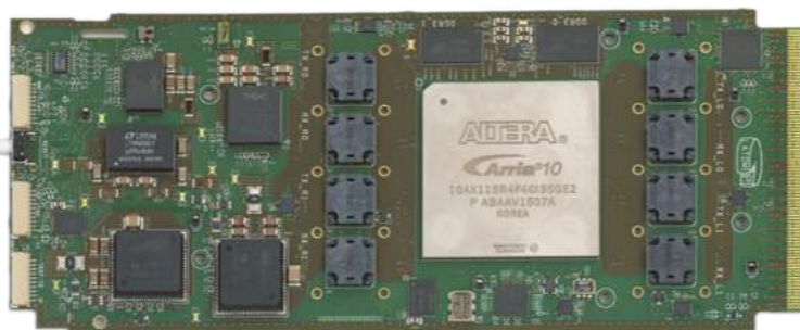
Figure 6 : Carte mezzanine de traitement digital, appelée LATOME.
