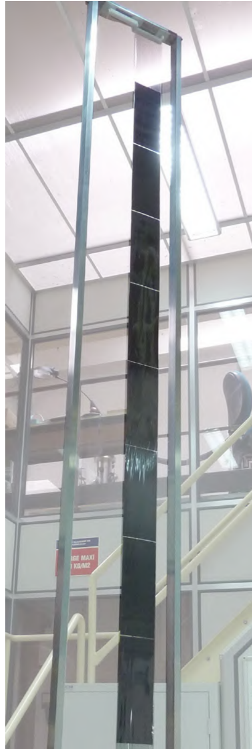
Figure 3 : La première feuille source obtenue en 2015 par la méthode développée au LAPP avec du Sélénium naturel.
