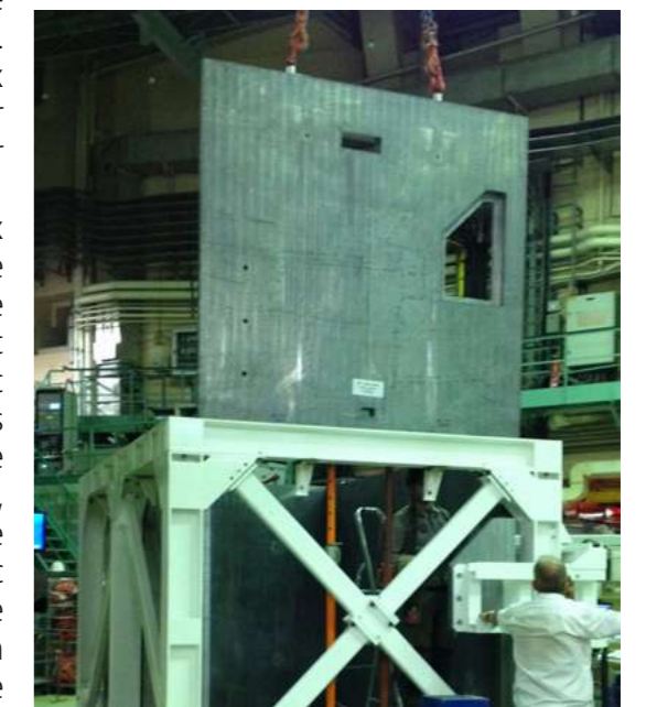
Figure 2 : Expérience STEREO lors du montage en été 2016 : châssis en acier (en blanc), plaque de blindage en plomb coulé (en suspension) et plaque de répartition, posée sur un tapis noir permettant le déplacement de l'ensemble sur des coussins d'air.
