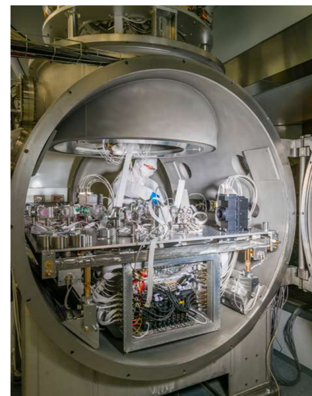
Figure 2 : Nouveau banc suspendu en sortie de l'interféromètre, inséré dans son enceinte à vide et suspendu. Le caisson étanche pour intégrer l'électronique de contrôle et de lecture au banc est ouvert. De nombreux éléments optiques, ainsi que des photodiodes et caméras dans leurs petits caissons étanches sont installés sur le banc.
