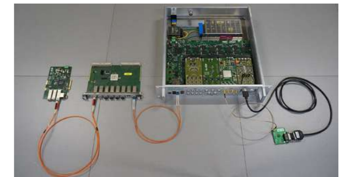
Carte DAQ BOX et cartes mezzanines multifonctionnelles, système de timing et transmission de données VIRGO.
