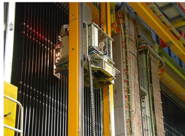
Figure 1 : Plateforme d'un des manipulateurs en position élevée le long du portique pour accéder une rangée de briques de la cible OPERA.
