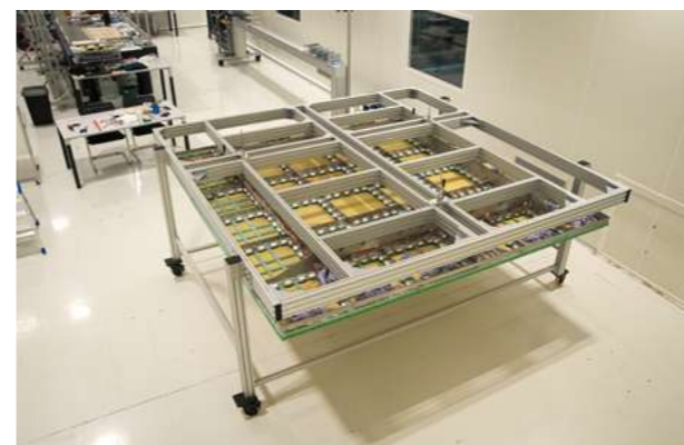
Photo ProtoDUNE : Un module CRP sur sa structure de construction et de transport.
