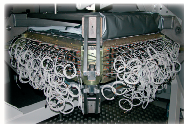
Le ECAL avec son électronique et les câbles pour la haute tension
