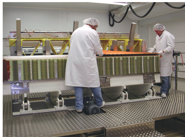
Figure 2 : Le module M8 en cours d'empilage
