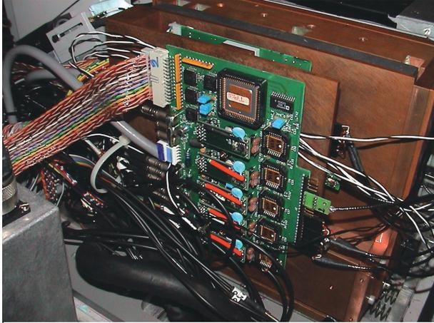
Figure 3 : Carte électronique avec injecteur pour le contrôle de la dérive des caractéristiques sous irradiation.
