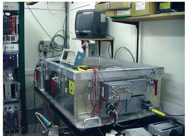
Figure 5 : Dispositif laser Ultra-violet pour l'excitation de la scintillation des cristaux de PbWO<sub>4</sub>
