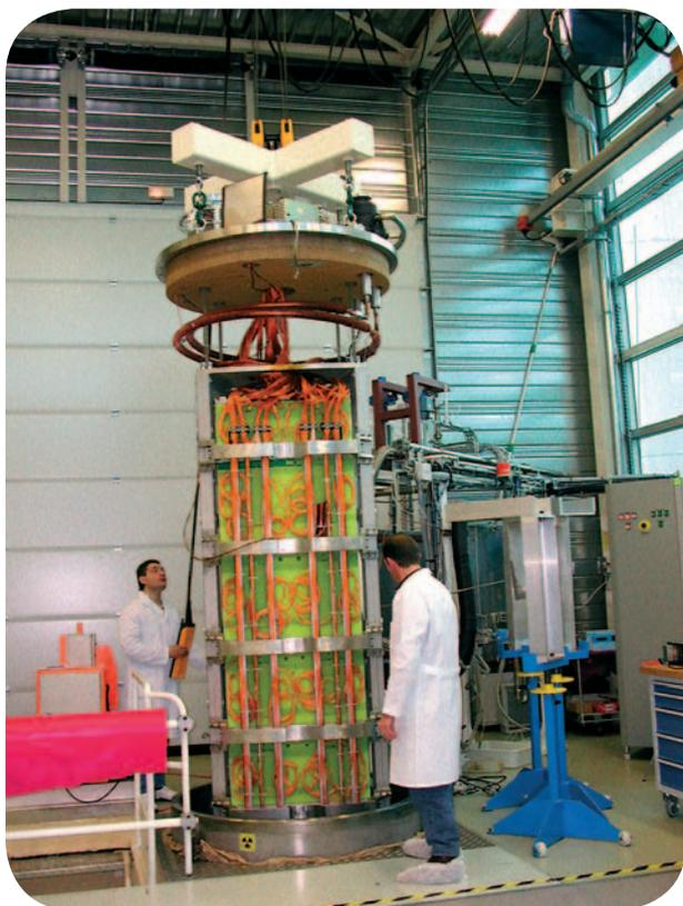
Figure 1 : Installation des tests de cryogénie, mise en place d'un module du calorimètre ATLAS.
