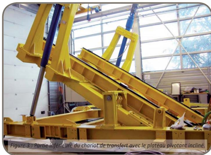
Figure 3 : Partie inférieure du chariot de transfert avec le plateau pivotant incliné.
