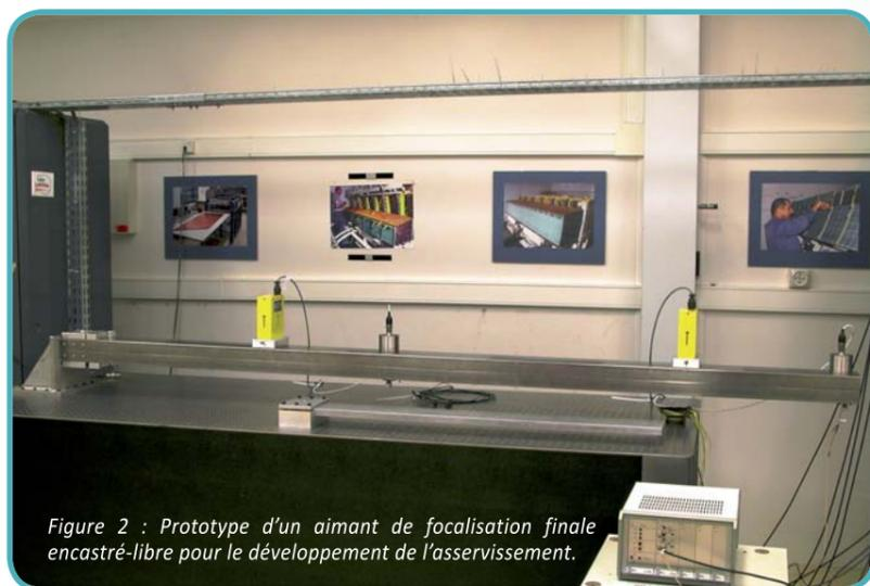
Figure 2 : Prototype d'un aimant de focalisation finale encastré-libre pour le développement de l'asservissement.
