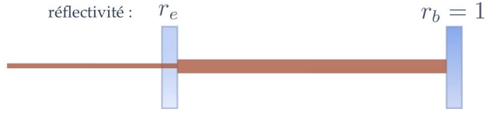
FIG. 11 – Principe d’une cavité Fabry-Pérot utilisée dans Virgo. La réflectivité du miroir d’entrée est r_e , celle du miroir de bout est égale à 1.
