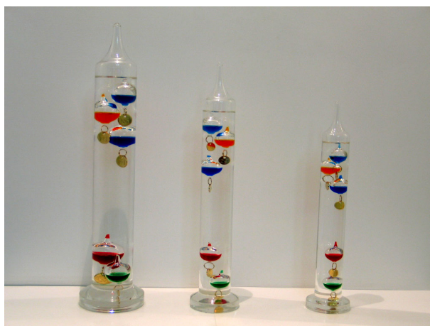
FIGURE 5.1: thermomètre de Galilée. La densité du liquide, et donc la flottaison d'un corps de densité donnée, dépend la température. En calibrant correctement les corps, on obtient un thermomètre.
