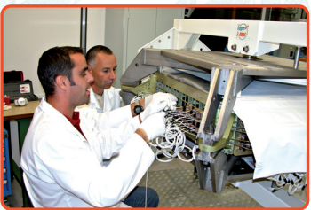
Montage des photomultiplicateurs (AMS)
