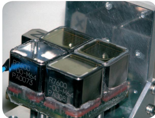
Figure 3b : L'ensemble équipé de ses 4 PMTs est installé sur le pont.
