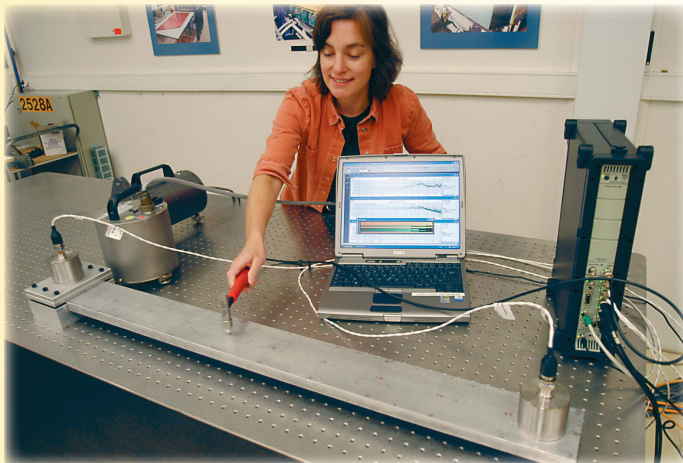
Campagne de mesures avec un marteau instrumenté et des capteurs de B&K sur une structure (poutre encastrée-libre) à stabiliser fixée sur une table active commerciale.
