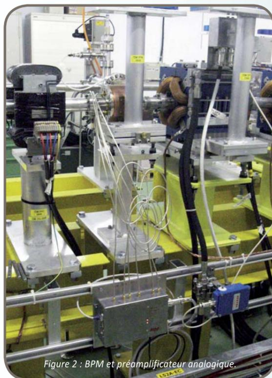
Figure 2 : BPM et préamplificateur analogique.
