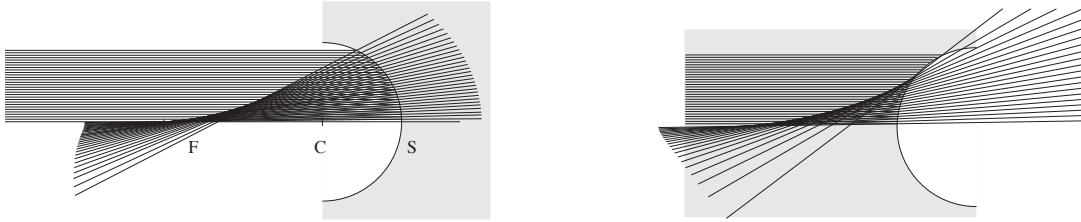
FIG. 2.17: marche des rayons réfractés et leurs prolongements, dans les différents cas de concavité et pour n_1 > n_2 et n_2 > n_1 .
